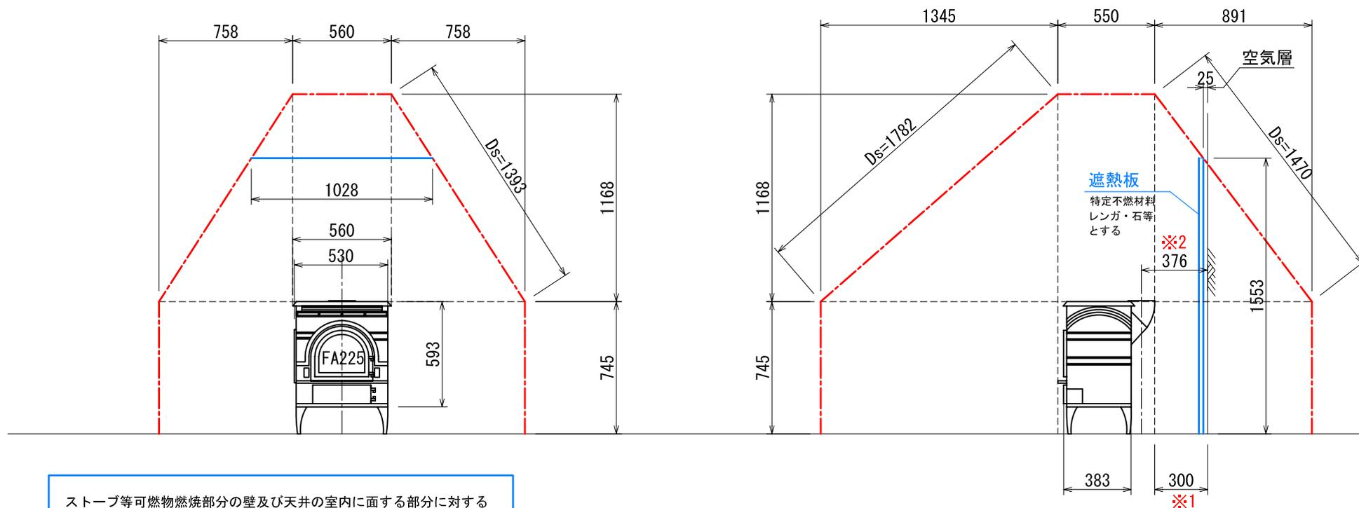
ストーブ等可燃物燃焼部分の壁及び天井の室内に面する部分に対する火熱（輻射熱・対流熱）の影響が上記の図の通り遮熱板を設け、有効に遮断されている場合は、遮熱板の後方は可燃物で仕上げて良い。
