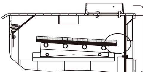
バッフルブランケットとバッフル板が燃焼室後部に接触していない。
