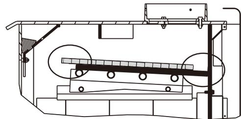
バッフルブランケットが、燃焼室後部に接触していない。前面ではバッフル板と平らになっていない。(その逆も同様)
