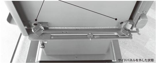
ACCの空気は、サイドの空気孔より入り込み、前面中央下から燃焼室に送られ、約20分後に自動で閉じます。リアエアは、レバー操作で手で空気量を調整します。
