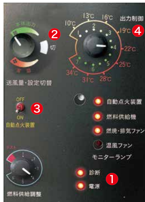
電源を入れると、温風ファン以外のインジケータランプが点灯します。
